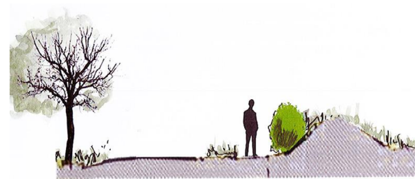
Coupe de principe d'une limite traitée avec un fossé (Source CAUE 41)
